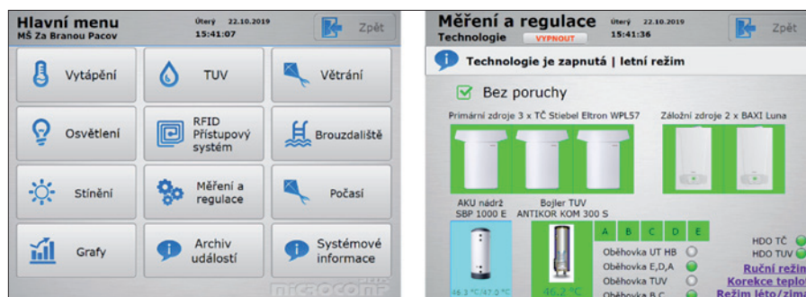
Obr. 2. Všechny technologie jsou přehledně sloučeny pod Tecomat Foxtrot a přehledně ovládány z jednotného systému přes tablet, mobilní telefon či obrazovku počítače.
