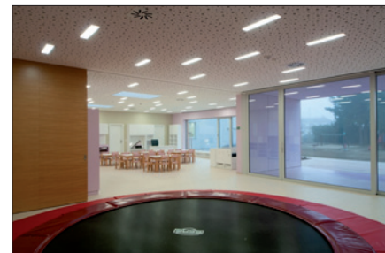
Obr. 4. Do prostorů, kde děti ve školce Za Branou tráví nejvíce času, se denní světlo dostává nejen okny, ale i několika světliky. Rovnoměrné teplo na tak velké ploše zajišťuje jediné podlahové topení. Výměna vzduchu aerostaty ve stropě je dnes nejen nutností, ale v novostavbách snad už i samozřejmostí.
